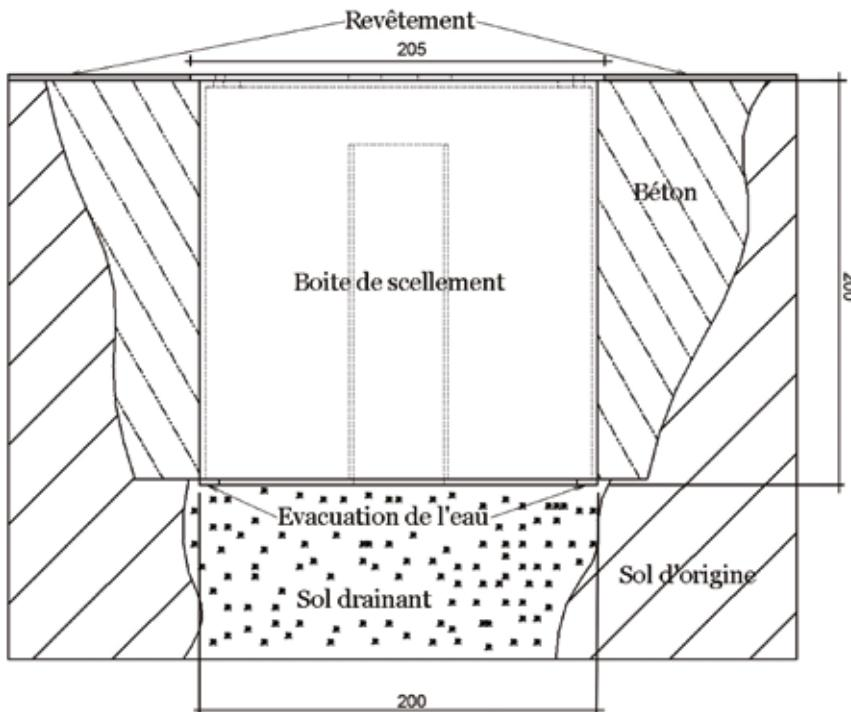
**ATTENTION : LORS DU SCELLEMENT DE LA BOITE, NE PAS NOYER LE FOND DE CELLE-CI DANS LE BÉTON POUR PERMETTRE L'ÉVACUATION DE L'EAU**
